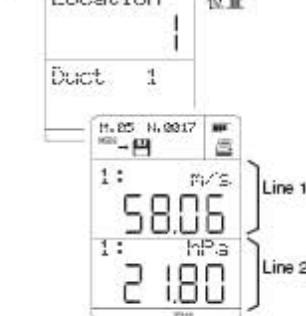
当前测量状态-根据不同的连接探头而不同
